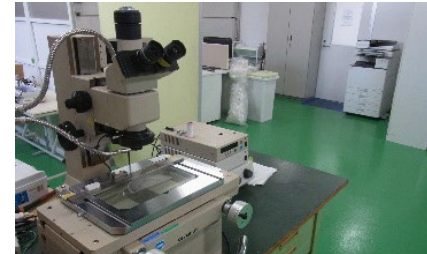
検査関連 ■工具顕微鏡 ■拡大鏡 (×2及び×4) ■導通・耐電圧検査装置 ■マイクロ스코プ (画像検査UNIT)
